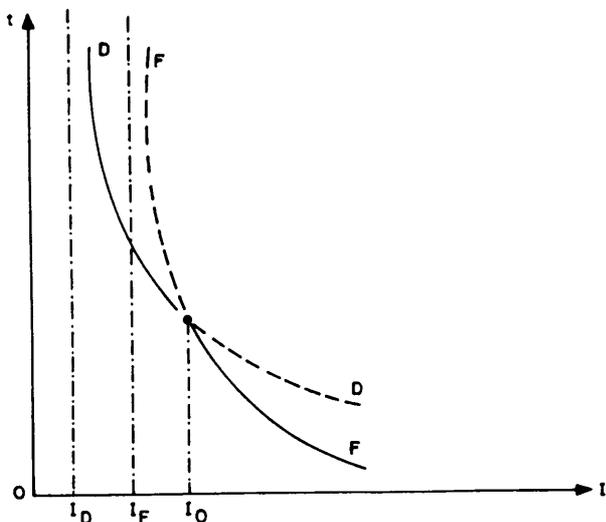
Pelo exame da figura verifica-se que, para qualquer corrente inferior a  $I_0$ , o disjuntor funciona primeiro, ao passo que, para intensidades superiores, o tempo de funcionamento do corta-circuitos fusível é mais curto que o do disjuntor.
