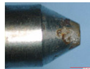
Válvula de expansão corroída
